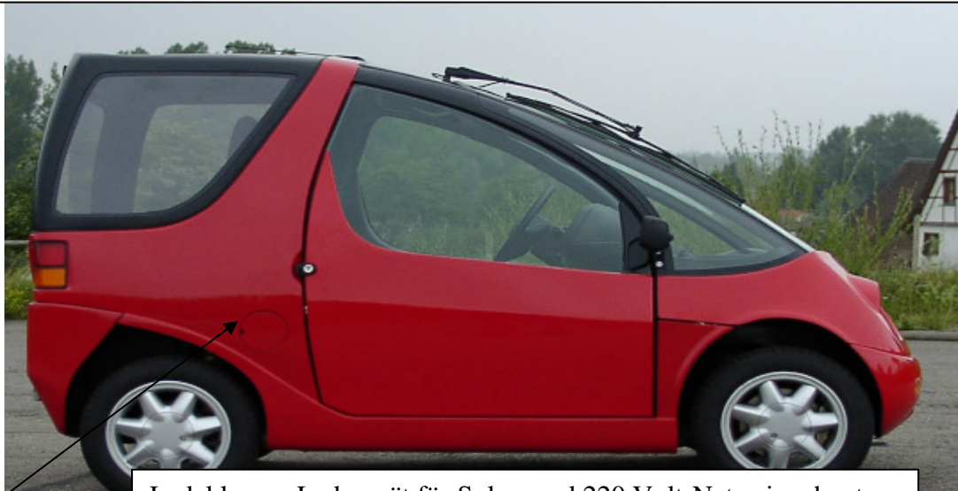
Ladeklappe: Ladegerät für Solar- und 220 Volt-Netz eingebaut
